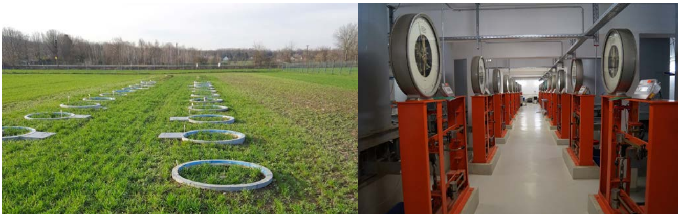
Abbildung 44: Blick über das mit Winterweizen bestellte Lysimeterfeld im Jahr 2021 (links) und in den Lysimeterkeller, der die Wägeeinrichtungen der Lysimeter beherbergt (rechts). Foto: Stefan Werisch
