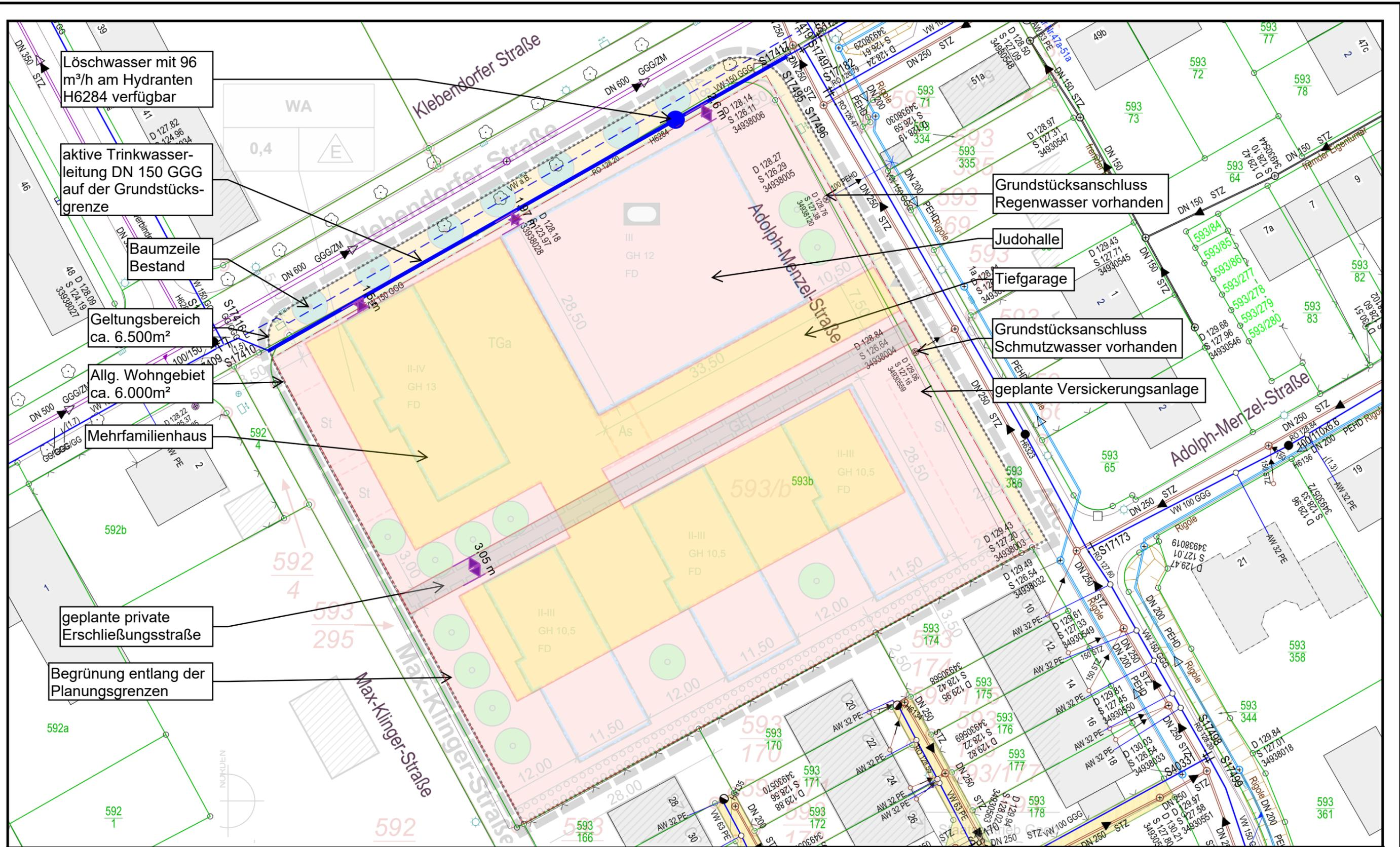
Löschwasser mit 96 m<sup>3</sup>/h am Hydranten H6284 verfügbar
