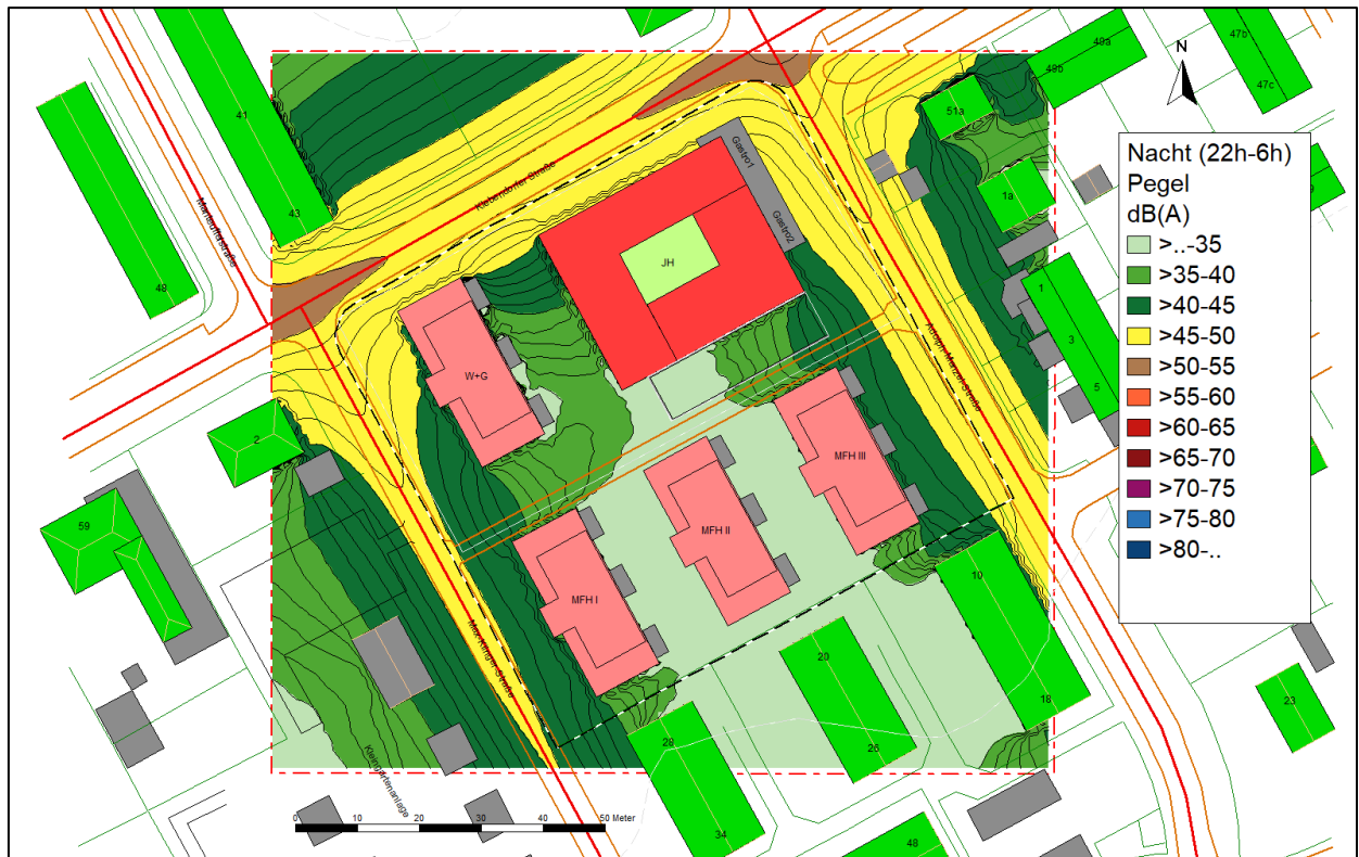
Abbildung 16: Raster Beurteilungspegel Straße im Nachtzeitraum (Bebauungskonzept) (Rasterhöhe 5 m über Grund, Rasterschrittweite 1 m)
