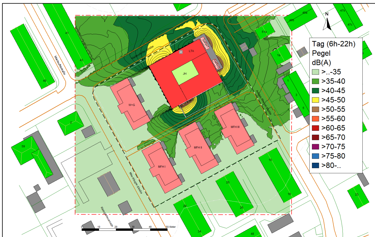
Abbildung 19: Raster Beurteilungspegel Judohalle im Tagzeitraum (Bebauungskonzept) (Rasterhöhe 5 m über Grund, Rasterschrittweite 1 m)
