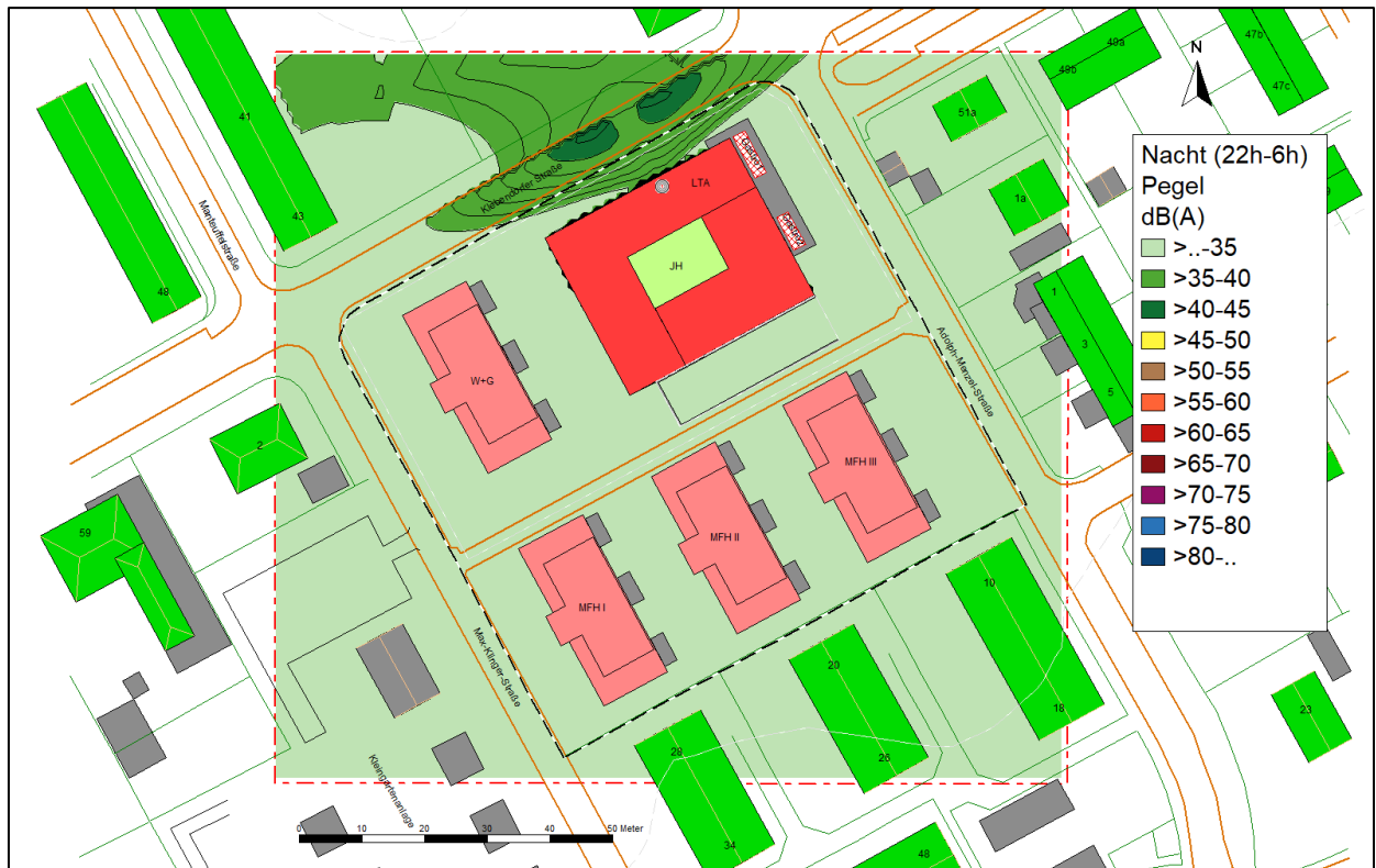
Abbildung 20: Raster Beurteilungspegel Judohalle im Nachtzeitraum (Bebauungskonzept) (Rasterhöhe 5 m über Grund, Rasterschrittweite 1 m)
