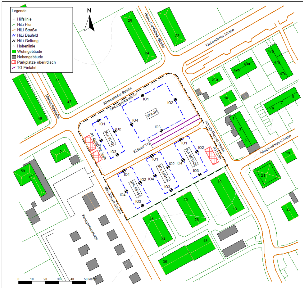
Abbildung 10: Anordnung der Immissionsorte IO auf den Baugrenzen der Baufelder WA
