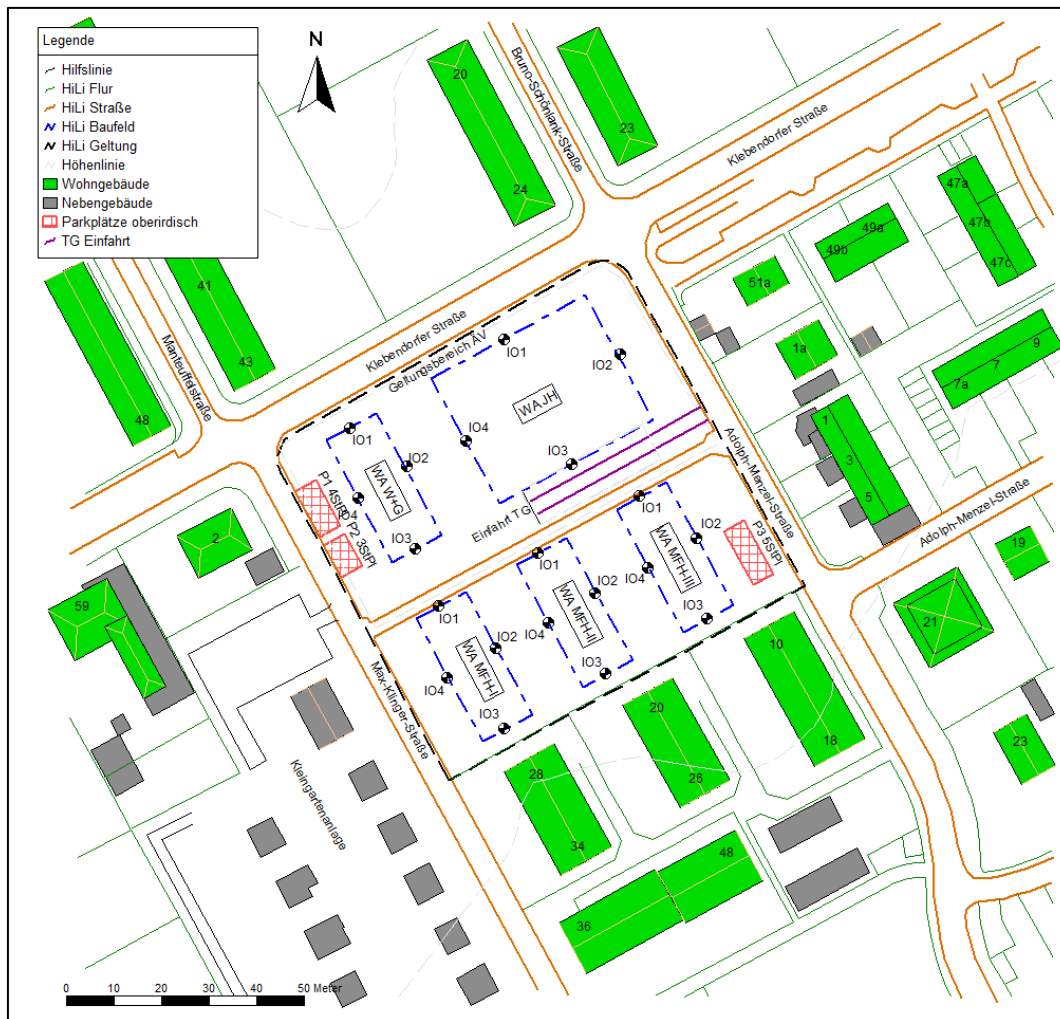
Abbildung 22: Lageplan (Rechenmodell) mit den Baufeldern WA W+G, WA JH, WA MFH-I bis WA MFH-III sowie den Immissionsorten auf den Baugrenzen
